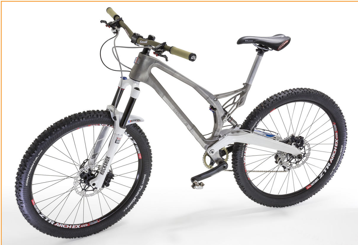
Kompletní kolo s rámem a objímkou sedlovky vyrobenými z titanu technologií 3D tisku
