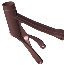
1. CAD model sedlovky navržené pro odlévání z hliníkové slitiny
