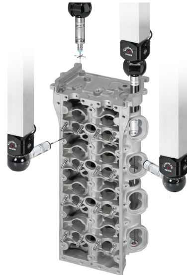
Des palpeurs modulaires et polyvalents sur têtes indexables peuvent renforcer la flexibilité et l'automatisation du contrôle en donnant accès à toutes les parties à mesurer en une seule configuration.
