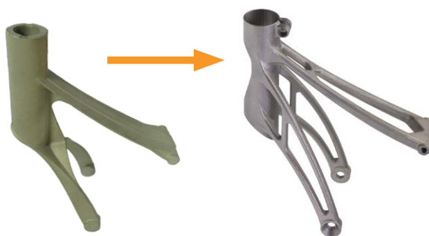
Support de selle de vélo en aluminium et support optimisé en titane. Une réduction de poids de 44 % a été obtenue en optimisant la conception par fabrication additive.
