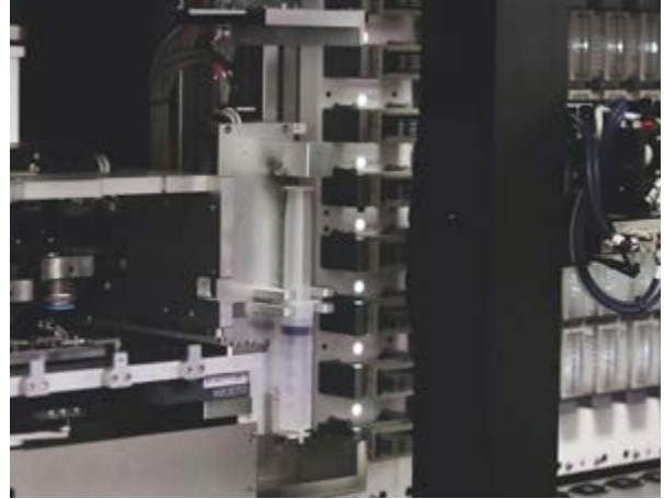
P1000 : 현미경 슬라이드 스캐너(좌측)와 샘플 스토리지 및 로봇 암(우측)
