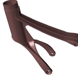
1. Sele borusunun CAD modeli alüminyum alaşım döküm için tasarlanmıştır
