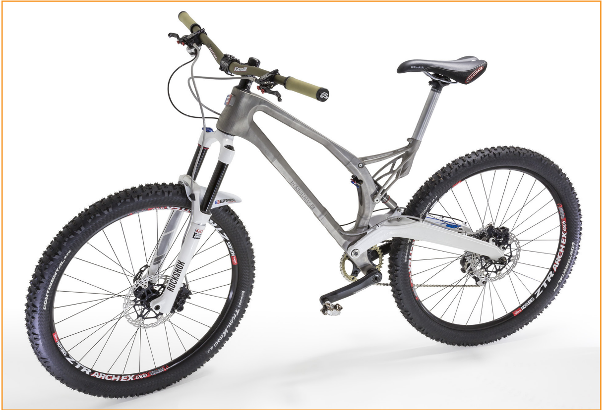
3 boyutlu baskılı titanyum alaşım gövde ve sele borusu yuvası ile bütün bir bisiklet
