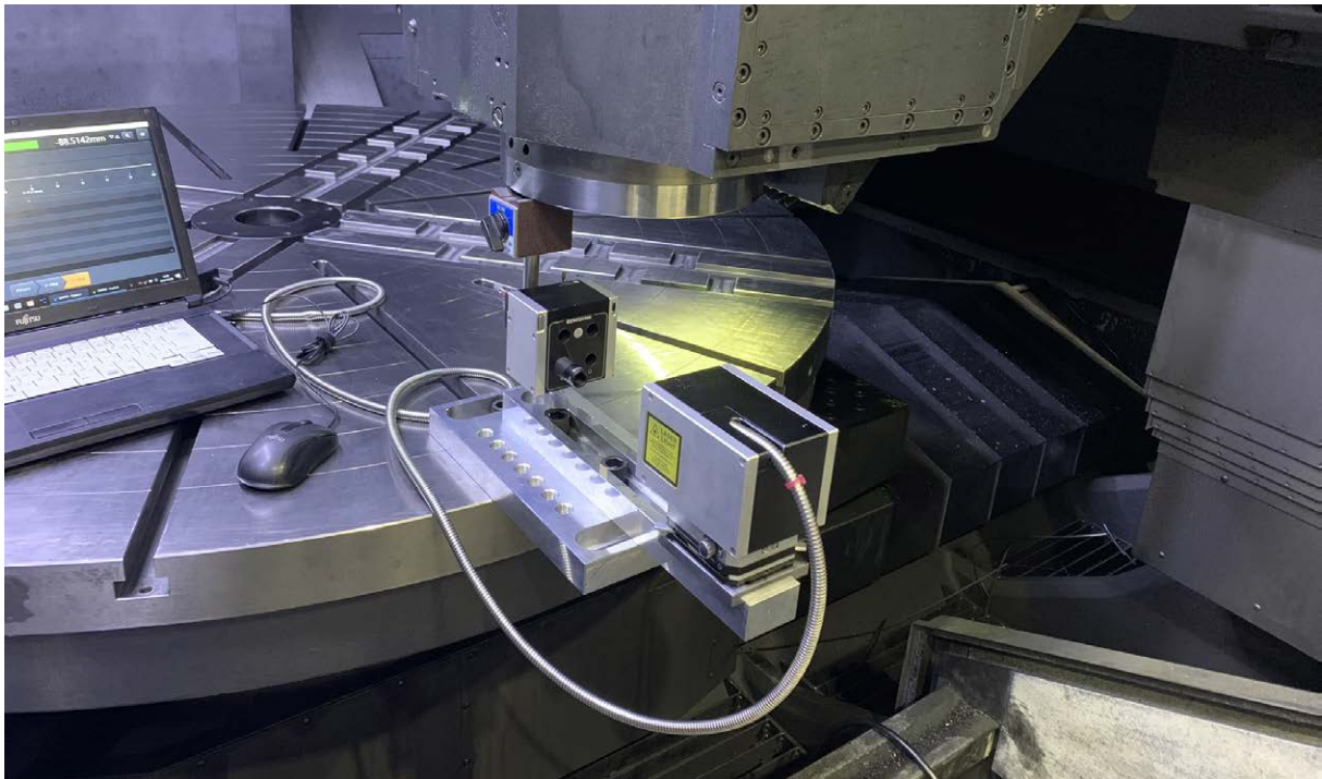
Misura dell'accuratezza di una macchina utensile con il sistema di calibrazione multi-asse XM-60
