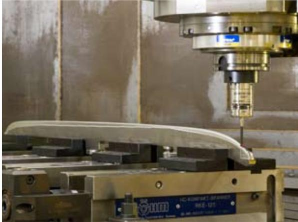
Dai dati acquisiti sono stati creati file CAD in formato DXF e IGES, inviati elettronicamente a Sescoi per la creazione di un programma tramite CAM. La lavorazione è stata eseguita presso la Iscar su una fresatrice DMG dotata di controllo Siemens Sinumerik. Al termine della lavorazione la forma dei pattini è stata verificata utilizzando un tastatore OMP400 di Renishaw che, grazie alla sua tecnologia estensimetrica, consente di effettuare misure in macchina con altissima accuratezza.
