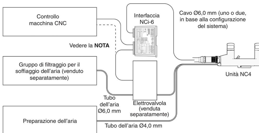
**NOTA:** l'elettrovalvola può essere controllata tramite un codice M, connesso mediante un relè ausiliario su NCi-6 (connettore CN2, pin 3, 4, 5 e 6). In alternativa, il codice M può essere connesso direttamente all'elettrovalvola.
