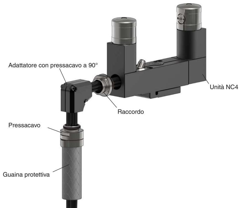
Cavo con connettore diritto collegato a un'unità NC4 con connettore
