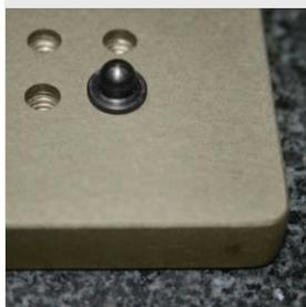
Sfera per garantire la ripetibilità di posizionamento delle piastre in Equator
